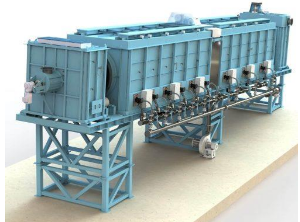
CHE:n pyrolyysiprosesseihin soveltuva uuni. Lähde: C.H.Evensen
